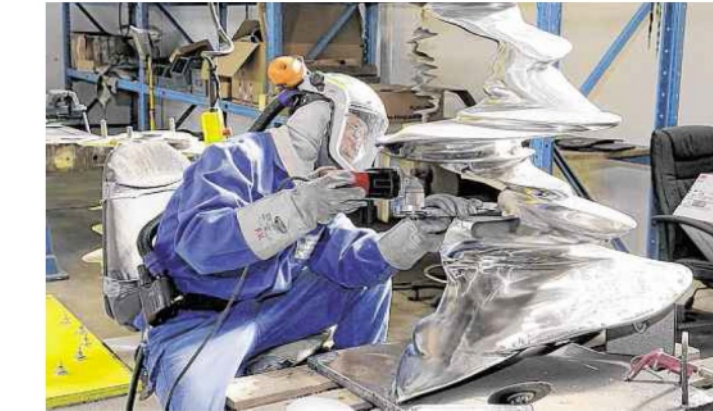
Ein Schmees-Mitarbeiter bearbeitet und veredelt unter Schutzkleidung die Gussteile. Foto: Ralf U. Heinrich
